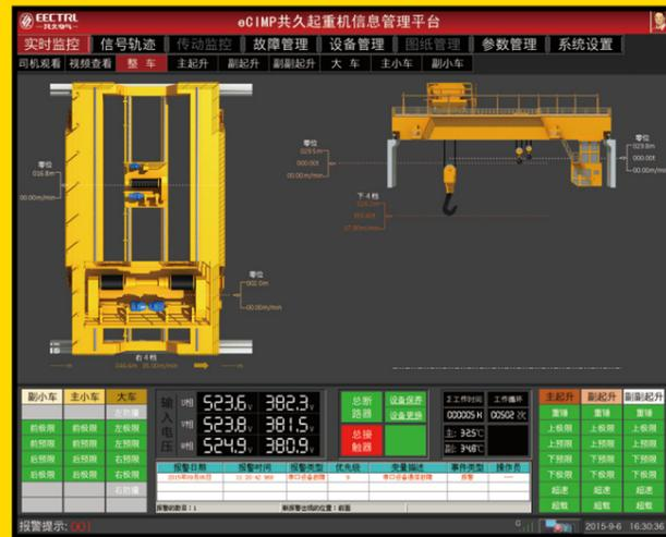
综合监控界面动画模拟起重机各个机构运行状态，直观形象；实时显示各个机构及总配电运行参数，包括供电电压，机构档位，速度，高度，位置，联锁状态，故障状态，保养提示等。
