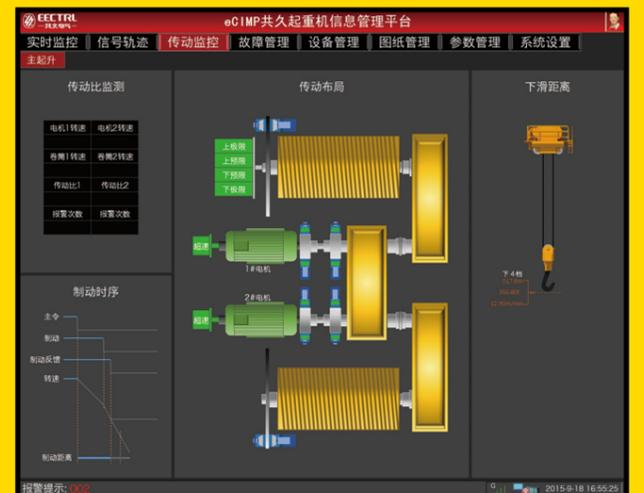
对于起升机构，传动的安全是至关重要的。传动监控界面通过采集高低速的速度信息，吊钩高度，制动系统信号，直观显示传动比，制动时序，回零下滑距离等要素，并及时预警。
