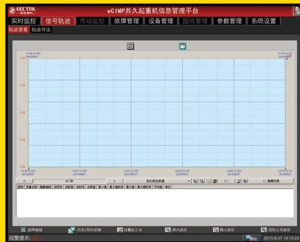
实时监控并记录用户预设的电控系统关键点的信号变化，通过分析某个时间段各信号的数值变化，可以判断起重机运行是否正常，是否存在安全隐患。如起重机发生事故时，通过回放事故时间点前后各相关信号轨迹的历史记录，可以还原事故瞬间起重机的运行状态，定位事故原因。
