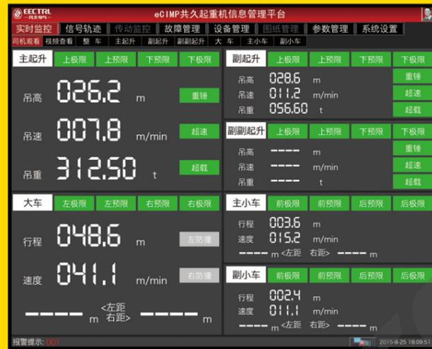
专为司机准备的状态观察界面，把所有机构的运行参数及故障状态集中于一屏显示，更便于司机观看。司机可以通过外部开关选择是否观看吊点视频。
