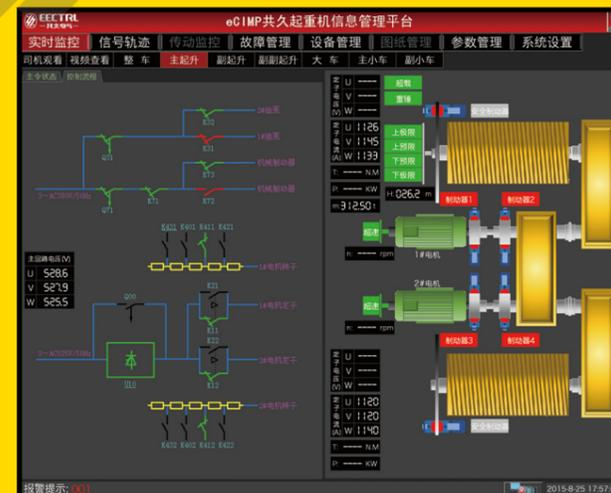
eCIMP 系统读取 PLC 内部参数，并绘制成电气原理图，显示元器件实时状态，点击某个元件可以查看其 PLC 控制逻辑，查找故障非常方便。
