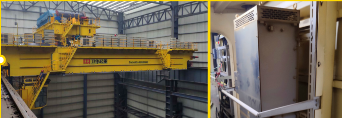
丽水华宏钢铁 2 台 240T 铸造吊 主钩电机 315KW×2 QY2-1500S/T5 380V 一拖二驱动
