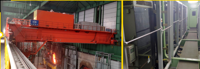
河北纵横钢铁 13 台 350T 铸造吊 主钩电机 560KW×2 QY3-2000S-A 500V 一拖二驱动
